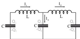
Die Frequenz beider Normalschwingungen muss gleich sein. In der 1. Normalschwingung ist  $I_3 = 0$ , somit könnte der mittlere Kondensator weggelassen werden.
